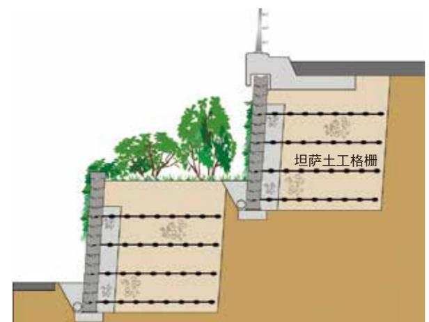
台阶式挡墙可以在台阶处种植树木和大型灌木。
